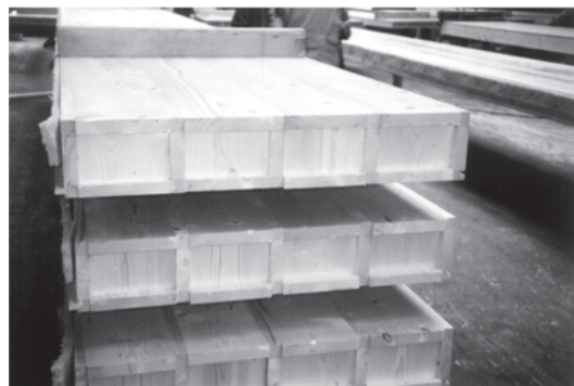
Placas huecas tipo "lignatur" en fábrica
