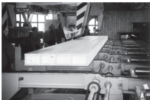
Placas tipo cajón (fábrica lignatur)
