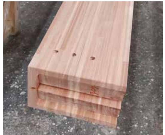
Figura 5. Fabricación y mecanizado de los elementos de madera laminada encolada de Red Grandis (Fuente: Simonin SAS)
