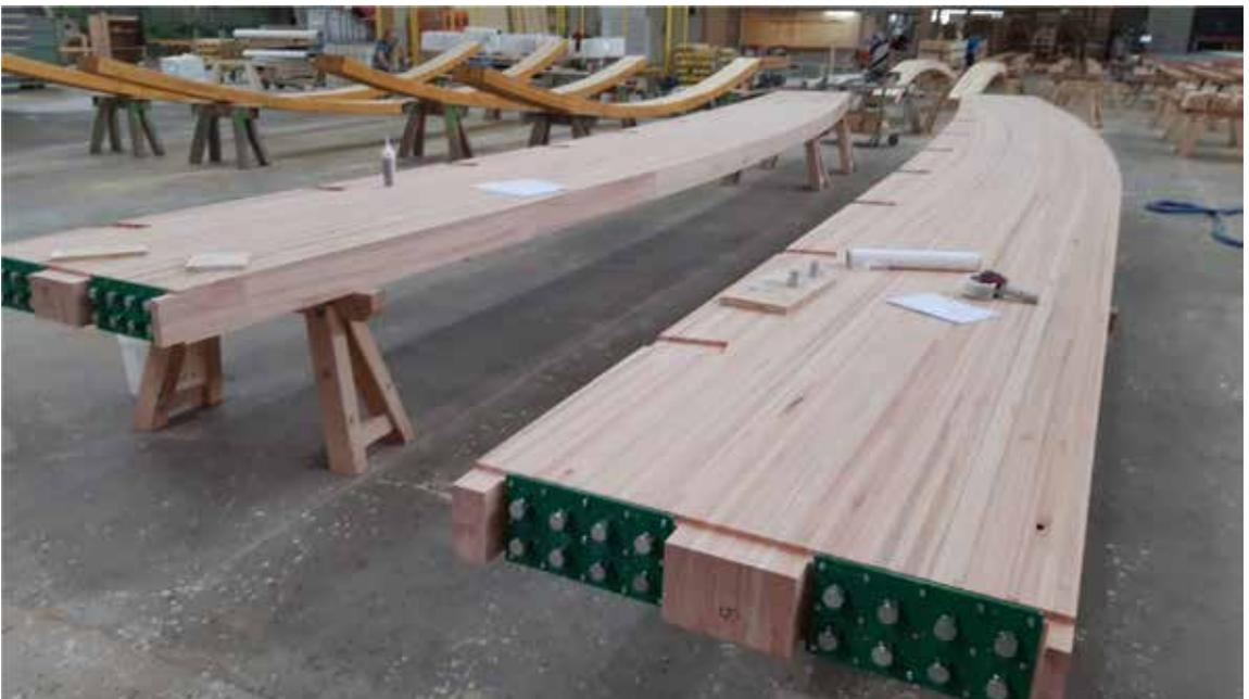
Figura 6. Detalle de las barras encoladas entre los tramos de viga
