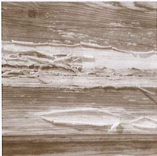
Foto 10 Degradación sufrida por los barnices sobre madera a la intemperie
