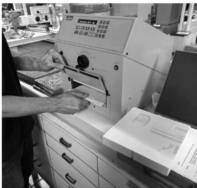
ENSAYO DE CONDUCTIVIDAD TÉRMICA.
