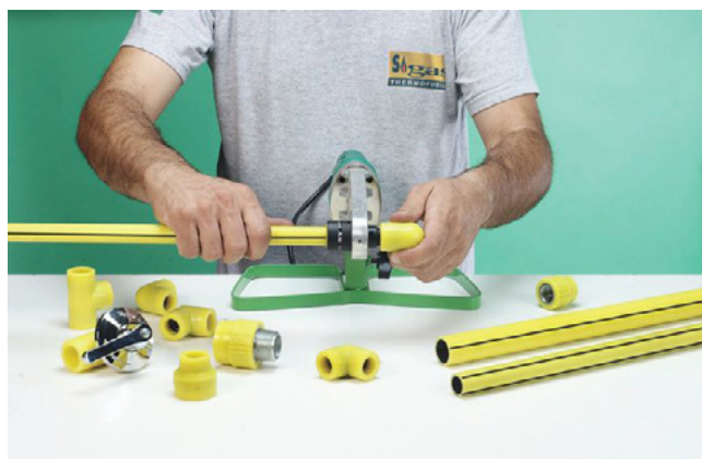
Calentamiento del tubo y el accesorio a 260°
