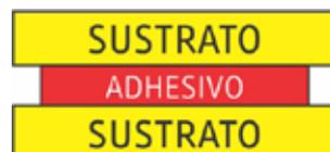
Los adhesivos son ventajosos para la unión de materiales delgados o diferentes, la reducción del peso, y cuando una amortiguación de las vibraciones se necesita. Una desventaja de los adhesivos es que no forman un conjunto instantáneo, a diferencia de la mayoría de los otros procesos de unión, porque el adhesivo necesita tiempo para curar.
